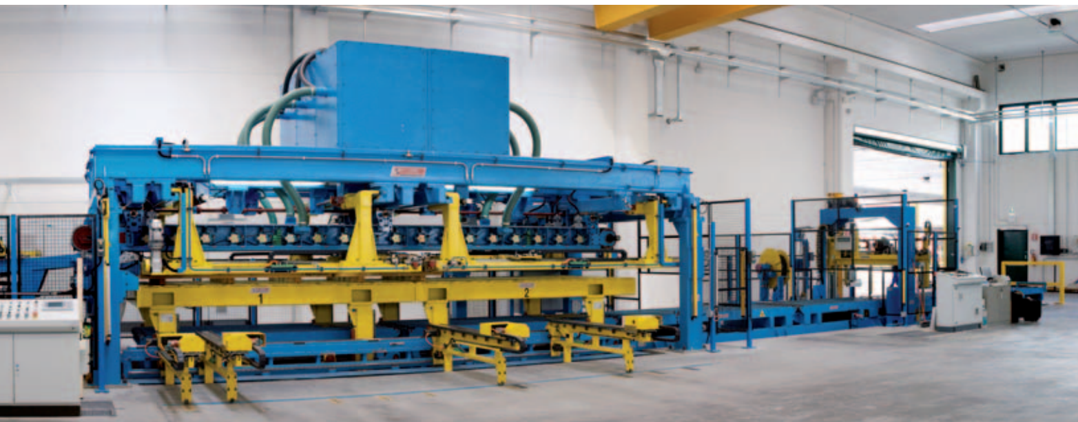
Linea di taglio trasversale 1.500 x 3,0 mm per nastri di acciaio inox con spessori da 0,5 a 4,0 mm, velocità linea 80 m/min.
