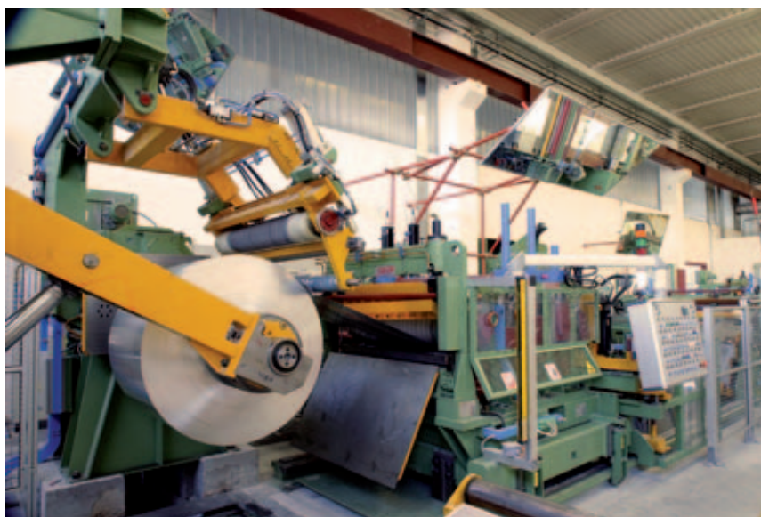
Linea di taglio longitudinale 1.500 x 3,0 mm per nastri di alluminio, velocità linea 450 m/min.
